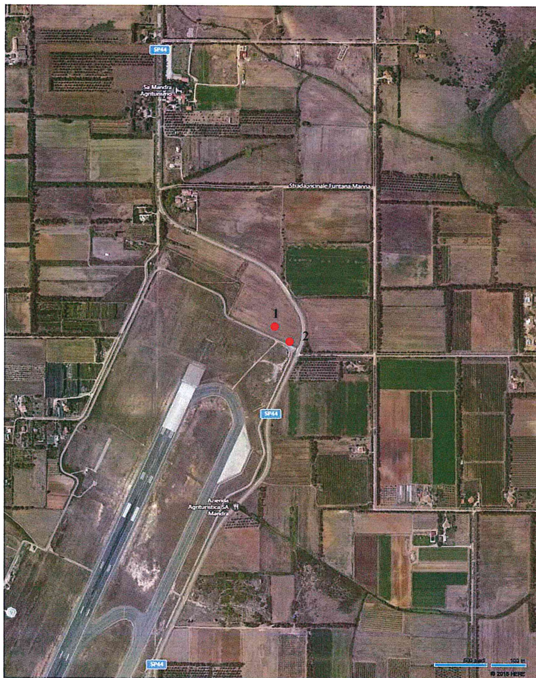
Fig. 1. Punti di misura in fase di decollo e atterraggio a circa 600 m dalla pista
