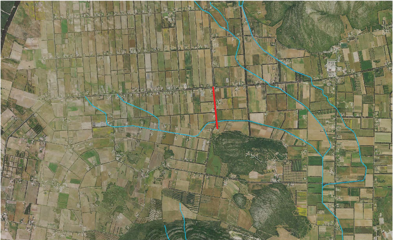
Figura 4 - individuazione su foto satellitare della sezione di chiusaura del bacino di calcolo
